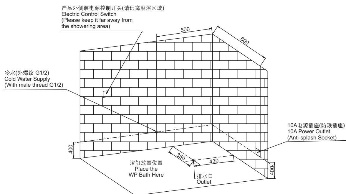
排水口应位于以图示排水口为中心，半径为250mm的范围内。
